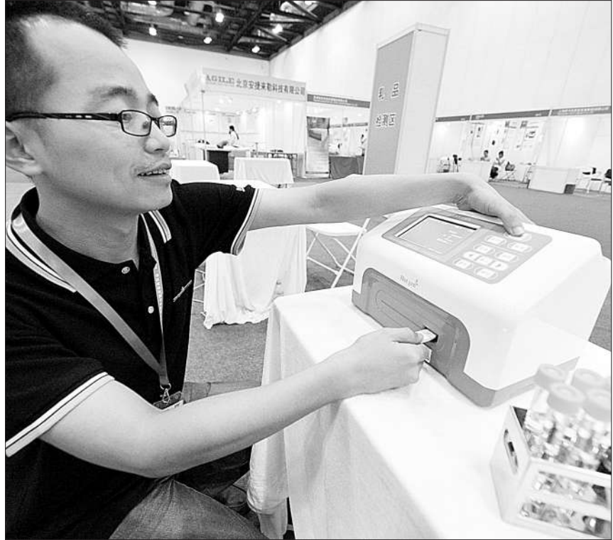
8月29日,中国国际食品安全检测设备展览会开幕,集中展示了国内外食品安全领域的最新技术和产品。图为北京热景生物技术有限公司利用稀土金属元素构成的晶体合成材料制作的具有完全自主知识产权的微生物快速检测仪及试剂。 本报记者 洪星摄
