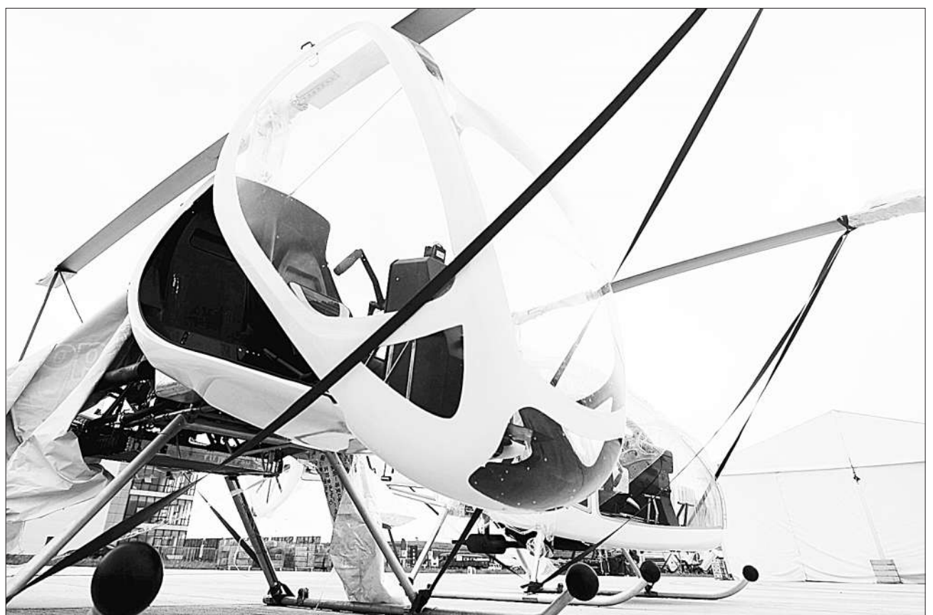
由天翼通用航空科技有限公司生产的农业植保专用Dyna11-h3直升机运抵辽宁沈阳法库国际飞行大会。该飞机造价低廉;可快速拆装,便于运输;最方便之处可加注普通97号汽油,不需航空专用油;可广泛用于农药喷洒,森林防火预警等。第三届沈阳法库国际飞行大会暨2014沈阳航展将于8月27日至31日在辽宁法库国际飞行大会举行。图为Dyna11-h3直升机。
