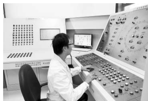
盾构及掘进技术国家重点实验室人员进行盾构掘进远程监控
