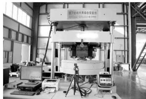
盾构及掘进技术国家重点实验室滚刀岩机作用实验台
