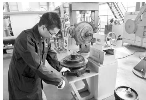
盾构及掘进技术国家重点实验室滚刀扭矩检测
