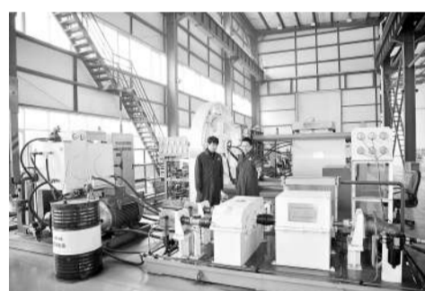
盾构及掘进技术国家重点实验室电流控制综合实验台
