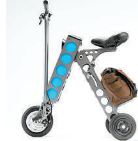
URB-E号称世界上最小的电动车,重量为11.3公斤,折叠后高度91厘米,充满电后最远可行驶32公里,最高时速24公里。因为可折叠,所以具有良好便携性,带着它乘坐公共地铁也很方便。设计者把中国作为URB-E主要的目标市场,未来就是要解决众多上班族的最后一公里通勤问题。
