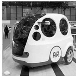
在大力提倡环保、开发新能源的今天,未来汽车,混合动力、纯电动,乃至氢动力或许都不再新鲜。根据德国媒体消息,由Motor Development International SA(MDI)公司研发的空气动力车AirPod即将在今年秋季实现量产。这款长2.13米、重达275公斤的车将使用类似游戏摇杆的操作柄。车辆标配碟式刹车以及三速自动变速器。拥有470升的储物空间和一个30升的冷藏箱。上市之后,AirPod将首先在欧洲市场面向汽车共享及企业车队领域投放。据悉,这种AirPod最低配置的车型预计售价在7500欧元左右。
