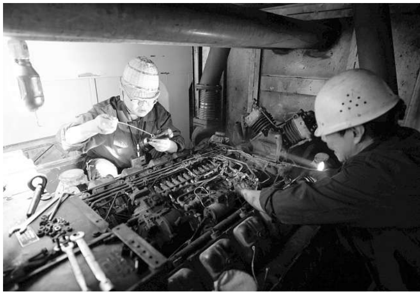
6月9日,在南昌铁路局鹰潭工务机械段九江检修车间,高级技师刘容带着技术人员正在对大型机械养路设备的进口发动机进行大修。只有高中文化的刘容自行摸索维修进口大机设备,通过分解检查发现了3起08车型车轴齿轮箱轴承损伤隐患,有效避免了行车安全隐患,并总结出油样分析参照数据。针对进口发动机故障检查判断困难,专业化要求高的实际情况,他结合自身多年的实践经验编写了发动机故障快速检查手册,便于维修人员学习和操作检查,实用性很高,对施工现场发动机故障检查和判断具有较强的指导作用。刘容先后10多次拒绝了德国、美国等国外驻中国公司的高薪诱惑。
