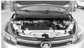
两款动力版本,分别配装在长城 C50 和哈弗 H6 两款车型上。这款1.5升发动机基于长城原有的 GW4G15 自然吸气发动机改进而来。与其他小排量发动机不同的是,长城1.5T仅使用了涡轮增压,而未采用缸内直喷技术,依旧使用进气道喷射方式。
