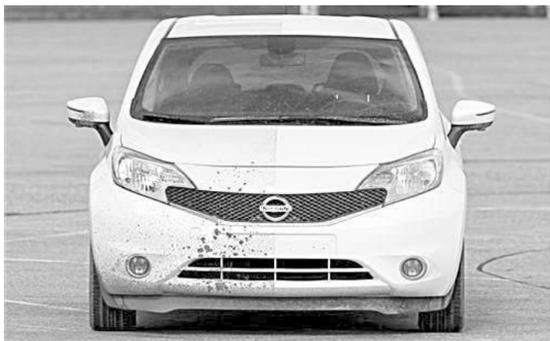
日产汽车近日宣称,公司目前正在测试一种特殊的超疏水疏油漆。由于该油漆排斥水和油,因此汽车会始终保持“自我清洁”的状态,无需定期清洗。据悉,该类型油漆将应用于日产未来的一系列车型。这是首次对车身制造应用一种叫做“超级干”的技术。通过油漆和环境之间建立一个保护层,将有效阻止积水和道路污渍,避免在汽车表面形成污迹。(何晓亮)
