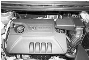
北汽代号为 A150 的1.5升涡轮增压发动机在采用了涡轮增压、缸内直喷技术外,还应用了启停技术和电子水泵。在发动机设计上,A150 采用了轻量化设计,将发动机缸盖与排气歧管进行了整合设计,使得体积进一步减小,可适用于不同车型使用。
