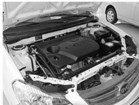
国内自主整车企业同样在进行小排量发动机的研发和应用。比亚迪 1.5TI 与不少小排量发动机一样,采用了涡轮增压和缸内直喷技术。目前在比亚迪思锐、速锐等车型上使用。此前,有消息称比亚迪将在新车上配装1.2T发动机,但目前仍在测试之中。
