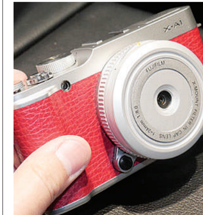
在刚刚开幕的CP+ 2014日本国际摄影器材展上,富士展出了一款规格为24mm f/8机身镜头,适用X卡口无反相机。镜头大部分采用塑胶材料制成,3组4片光学结构,等效焦距37mm,最近对焦距离1m,内置有柔焦、十字滤镜。
