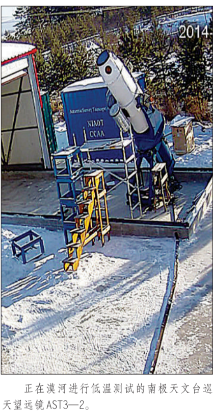
正在漠河进行低温测试的南极天文台巡天望远镜AST3—2。
