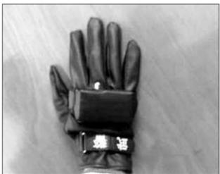
为解决警棍、盾牌等武器体积较大、不便携带的缺点,进一步提升官兵执勤处突作战能力,武警工程大学信息工程系牵头成功研制出新型反恐利器“防暴擒拿抓手”,并获国家实用新型专利认证。“防暴擒拿抓手”可瞬间释放高达3万伏的高电压,在对方不易察觉的情况下,通过电流将不法分子击倒制服。具有携带方便、操作简单、隐蔽性强等特点。
