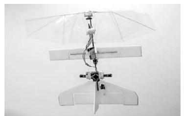
据国外媒体报道,荷兰代尔夫特理工大学的一组工程师研制出世界上第一架能够自驾的超轻型微型飞机。这款飞机名为“代尔夫特探险者”,它能够在没有飞行员驾驶的情况下在空中盘旋9分钟。它的重量只有约18克,能够像鸟一样拍打机翼。借助于搭载的视觉系统、处理器和陀螺仪,“代尔夫特探险者”可以自行导航,在飞行过程中避开各种障碍。
