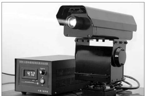
武警工程大学理学院李宏昌教授研制成功车载非杀伤激光眩目器。该装备由控制、激光以及车载云台3部分组成,在500米范围内可用扩展绿色强激光攻击、震慑恐怖分子及犯罪嫌疑人,驱散大规模闹事人群,提高部队在复杂环境下处突作战的效能。(海拉提)
