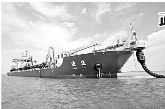
近期,中交天津航道局有限公司(以下简称天津局)天津港30万吨级航道疏浚工程的施工中,利用由“通途”轮等组成的目前国内最先进的耙吸挖泥船,在航道挖泥装舱并运至吹填区,然后采用接管吹的方式,通过排泥管线将疏浚土输送至吹填区
