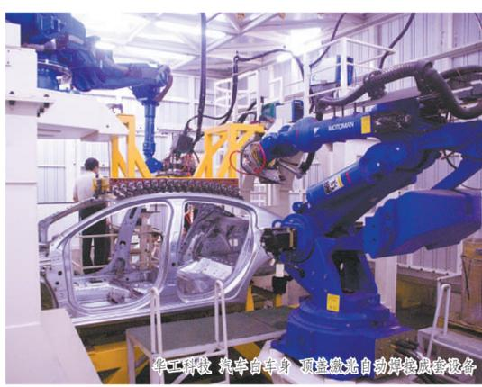
华工科数 汽车车身 顶盖激光自动焊接成套设备
