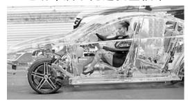
汽车亮相法兰克福车展,展示新一代汽车安全技术。透明 车装有一个先进雷达,提醒驾驶者可能发生的碰撞。此 外,车上还装有缓冲制动装置、紧急制动装置和新型主动 安全带系统,能够在发生相撞事故时减少车内人员承受的 撞击力。天合汽车集团表示他们的系统能够提供更理想 的踏板感,总体重量较低,性能优于传统系统。
