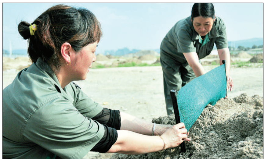
在中科院寒区旱区环境与工程研究所科研人员的技术支持下，甘肃一家企业研发了植物纤维阻沙网等多种阻沙固沙新材料，有效解决了塑料网因抗老化能力弱、不可降解带来的环境污染问题。8月20日，操作人员在演示固沙网的使用方法。 新华社记者 张文静摄
