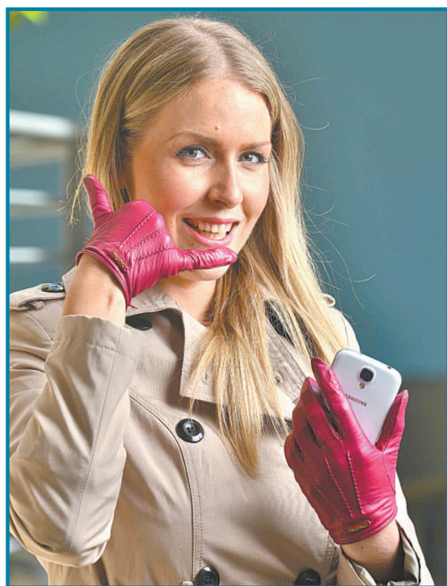
▲英国设计师将旧电话的零件加入皮手套内,制造出了手套电话。手套大拇指位置装有扩音器,尾指有麦克风,通过蓝牙连接手机。设计这个手套电话,是希望提高大家的环保意识。
