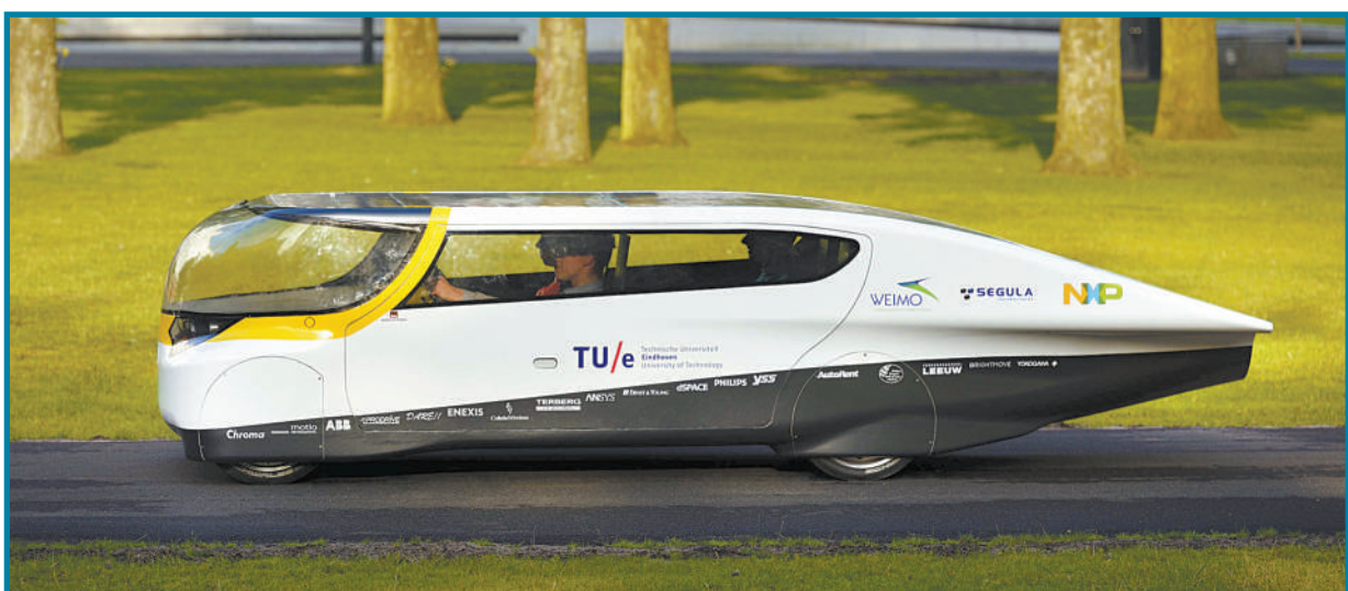
▲荷兰埃因霍温科技大学的研究团队设计的全球首辆太阳能家用汽车。该车采用高效太阳能电池和轻质车身设计,总重380公斤,拥有驾驶室和后排座椅,可容纳一家四口。借助车顶端太阳能电池板储存的能量,该车最远行程可达约676公里。
