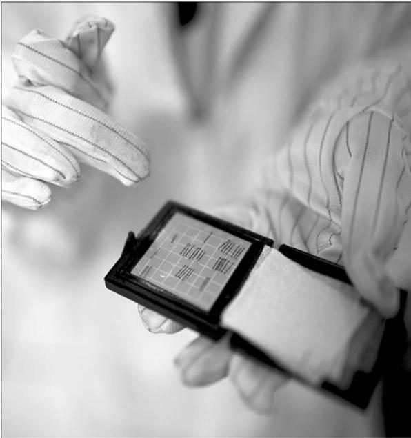
利用安装在13.7米毫米波望远镜上的超导成像频谱仪,南京市中科院紫金山天文台的研究人员提出银河关键切面——银道面巡天计划,即“银河画卷计划”。该计划将利用8—10年的时间完成该区域数据获取和处理任务,实现重要恒星形成区的微观组成、年轻星天体的发现等一系列科学目标。图为7月30日,研究人员在介绍应用在超导成像频谱仪上的超导隧道器件芯片片。
