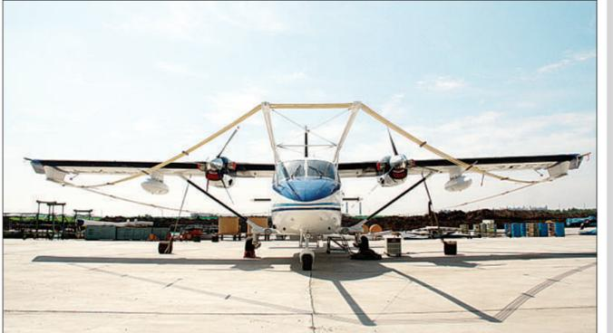
图为改装后的国产Y12型轻型固定翼飞机,时间域固定翼航空电磁勘查系统搭载在该飞机上。
