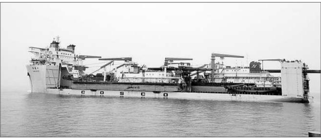
5月12日，在福建公安边防总队福清边检站，中国籍半潜驳“祥瑞口”轮搭载9029型挖泥船缓缓驶离福清江阴码头，顺利出境。据了解，半潜驳“祥瑞口”轮是中远航运股份有限公司为满足全球深海油田开发和建设运输需求而量身订造的特种船舶，该船总长216.7米，宽43米，深13米，甲板总面积达7000多平方米，超过一个标准足球场，最深可下潜26米，载重量5万吨，是目前世界上能够承运单件货物最大、设备最先进的船舶之一。
